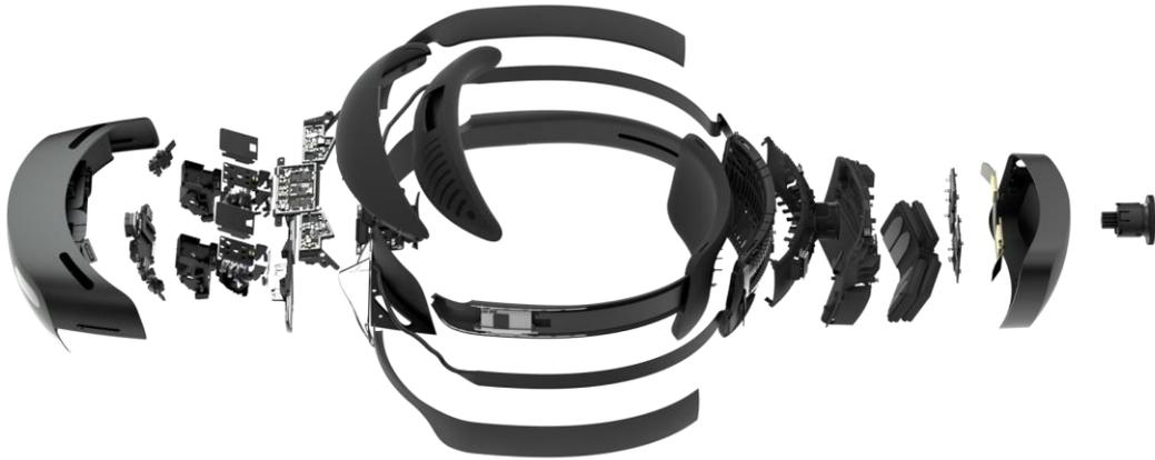
図：HoloLens 2の分解写真<sup>48</sup>
