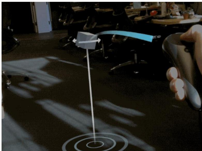
図：コントローラーを用いたARオブジェクトの操作に関するプロトタイプの例。白いCubeを使ってインタラクションの試作を行なっている。<sup>61</sup>
